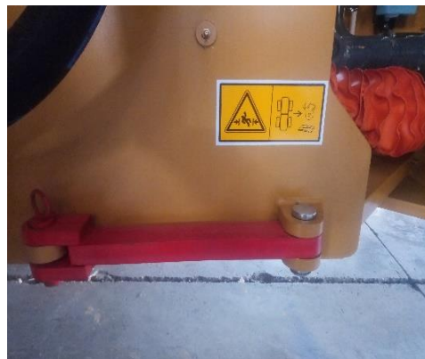
اهرم قفل کمرشکن لودر استفاده از دنده پنج زیر چرخ کفی یا کمرشکن
