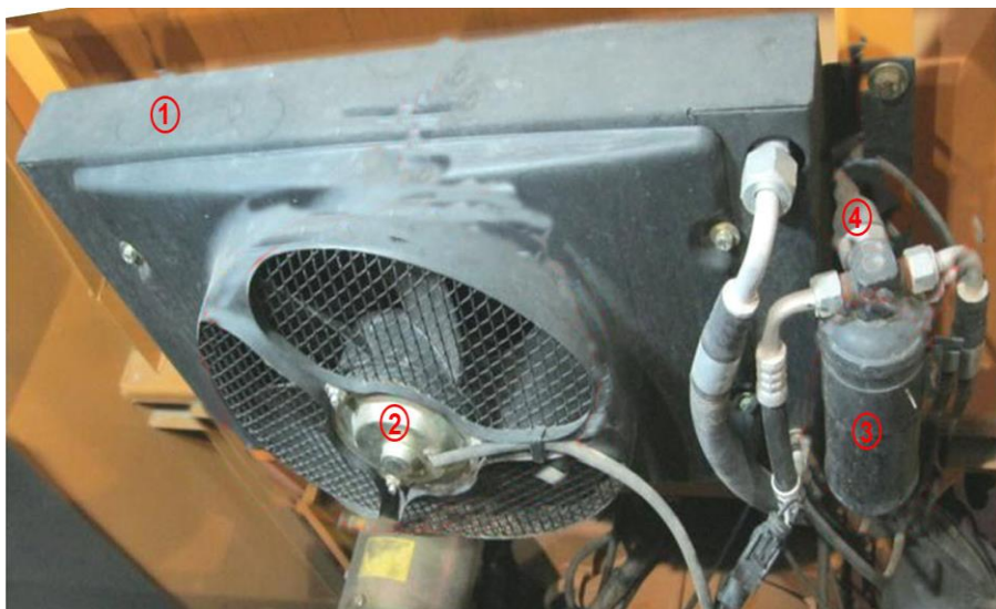
۱- کندانسور ۲- فن خنک‌کن ۳- رطوبت‌گیر ۴- فشنگی فشار مبرد
