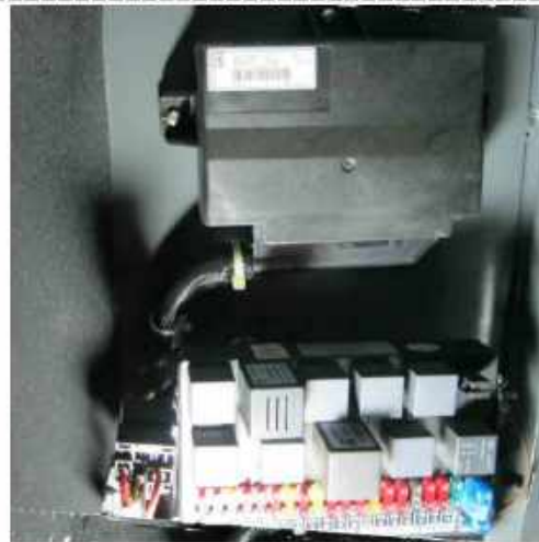
کنترلر الکترونیکی IC که در کنار رله‌ها قرار دارد.
