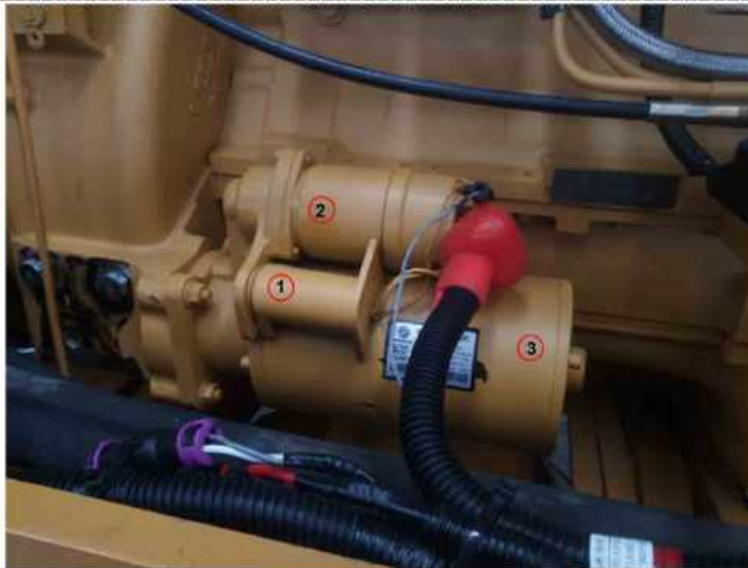
۱- رله الکترومغناطیسی ۲- اتومات استارت ۳- موتور استارت
