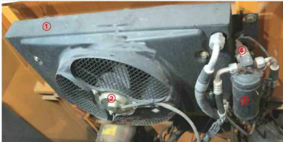
۱- کندانسور ۲- فن خنک‌کن ۳- رطوبت‌گیر ۴- فشنگی فشار مبرد
